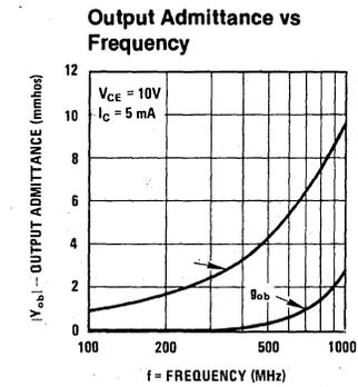
COMMON EMITTER Y PARAMETERS VS FREQUENCY
