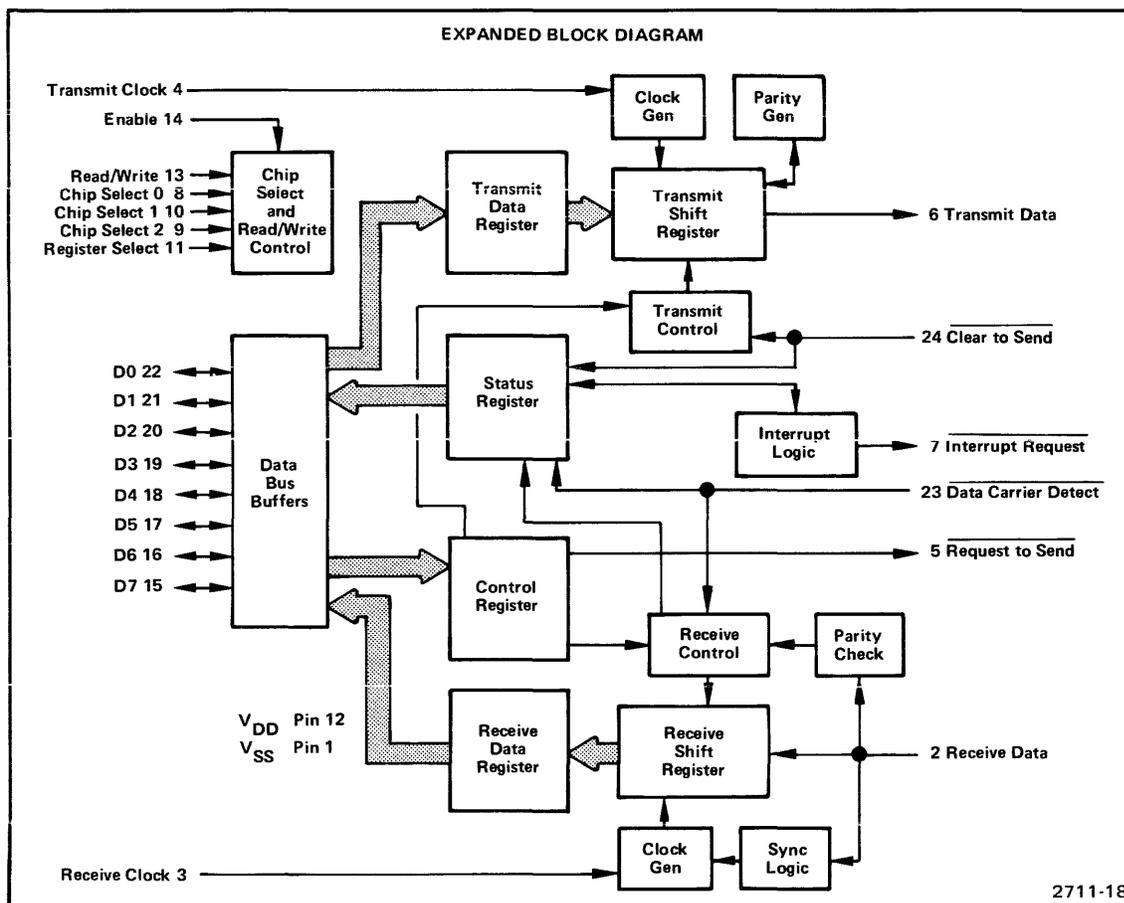
Fig. 5-2. ACIA Block Diagram.
